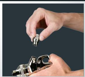
DE Passenden Schraubadapter an der Spritzpistole befestigen [siehe Adapterliste].
