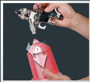
DE Becher durch Drehen und gleichzeitiges Ziehen entfernen.
