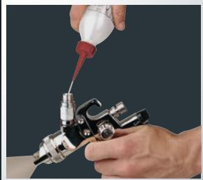
**DE** Abzugsbügel betätigen und gleichzeitig Reinigungsmittel zuführen. Bis zur vollständigen Reinigung forsetzen.
