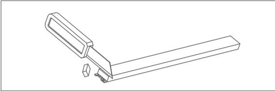
Entfernen Sie vorsichtig mit einem scharfen Messer die Silikon Beschichtung von den Kontaktstellen. Schneiden Sie nicht zu tief da sonst die Platine des LED-Bandes beschädigt werden könnte! Überprüfen Sie ob die Kontaktstellen frei von Silikon sind damit sie weiterverarbeitet werden können!
