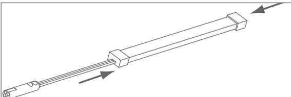
Prüfen Sie ob das LED-Band und die Enden fest verbunden sind und entfernen Sie den überschüssigen Kleber mit einem sauberen, trockenem Tuch. Lassen Sie den Kleber min. 1 Stunde trocknen bevor das LED-Band weiterverarbeitet wird.
