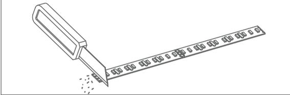
Entfernen Sie mit vorsichtigen schabenden Bewegungen die NANO Beschichtung von den Kontaktstellen. (ACHTUNG: Kupferanschlüsse dürfen nicht beschädigt werden!)
