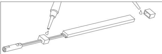
Um die ursprüngliche IP-Schutzart wieder herzustellen müssen die Trennstelle versiegelt werden! Drücken Sie zunächst genügend vom mitgelieferten Dichtkleber in die Endkappen und schieben Sie diese dann über die Enden des LED-Bandes.
