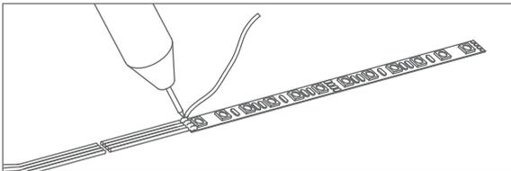
Die Kontaktierung des LED-Streifens erfolgt durch Anlöten der Zuleitungen an den vorgesehenen Lötstellen. Achten Sie dabei auf eine ausreichende Isolation zwischen LED-Band und Profil um Kurzschlüsse zu vermeiden.
