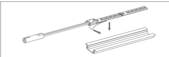
Kleben Sie die Module mithilfe des an der Rückseite angebrachten Klebestreifens direkt in das Profil. Das Profil muss trocken und frei von Verunreinigungen sein.
