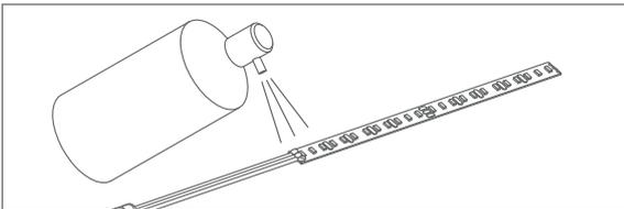
Um die Schutzklasse und den gefahrlosen Einsatz in Feuchträumen zu gewährleisten muss die Lötstelle versiegelt werden! Benutzen Sie dazu handelsüblichen Plastik Isolier- und Schutzlack. LED-Chips schützen!
