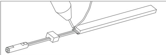
Die Kontaktierung des LED-Streifens erfolgt durch Anlöten der Zuleitungen an den vorgesehenen Lötstellen. Achten Sie dabei auf eine ausreichende Isolation!
