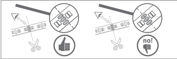
Nehmen Sie zuerst Maß! Die Lichtbänder können mit Hilfe einer Schere mühelos auf die gewünschte Länge gekürzt werden (Teilung beachten!). Auf ausreichende Kontaktfläche für das Anlöten der Anschlußleitung ist zu achten! Um eine fehlerfreie Funktion zu gewährleisten sollte der Biegeradius 10 mm nicht unterschreiten und darf nicht über scharfe Kanten geführt werden! Vermeiden Sie das Scheuern des LED-Bandes an beweglichen Teilen.
