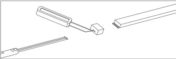
Schneiden sie mit einem Messer eine Endkappe längsseitig ein und führen sie das Kabel durch die Öffnung.
