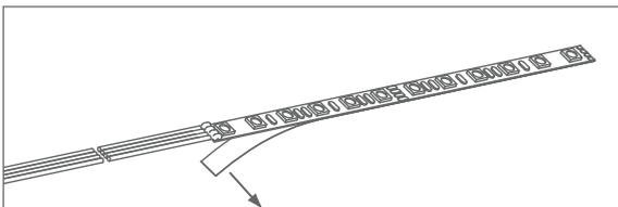
Das LED Band ist rückseitig mit einem Klebeband versehen. Um eine optimale Verklebung des LED-Bandes zu gewährleisten, muss der Untergrund auf dem das Band befestigt wird absolut staub- und fettfrei sein.
