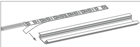
Kleben Sie die Module mithilfe des an der Rückseite angebrachten Klebestreifens direkt in das Profil. Das Profil muss trocken und frei von Verunreinigungen sein. Wichtig dabei: befestigen Sie das Modul mittig im Profil. Dabei vermeiden Sie die Berührung der Lichtpunkte.
