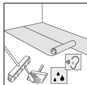
**⚠️** Bei vorhandenen Holzuntergründen muss auf eine Dampfsperre verzichtet werden. Hier kann z.B. unsere Unterlage JK160 genutzt werden.
