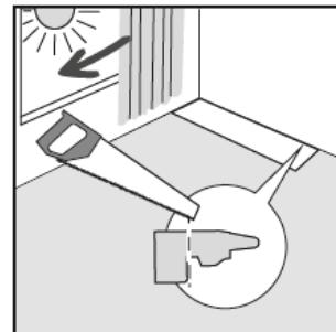
Halten Sie bereits bei der ersten Elementreihe und anschließend zu allen weiteren aufsteigenden Bauelementen (Wände, Säulen, Heizungsrohre etc.) mindestens 10 mm Abstand. Dies kann durch Abstandskeile bewerkstelligt werden. Nichtbeachtung führt zu einem eingespannten Zustand der schwimmenden Konstruktion. Dies führt zu Aufwölbungen im Bodenbelag und in der Folge ggf. zur Zerstörung des Bodenbelags.
