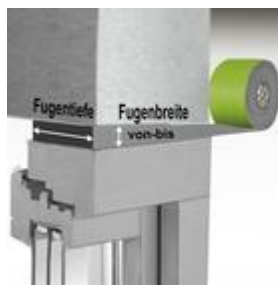
Bild 1: Die Fugenbreite sollte in der Mitte des Einsatzbereiches ermittelt werden. Die Toleranzen sollen berücksichtigt werden.
