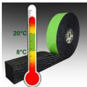
Bild 5: Lagerung und Verarbeitung von TP653 zwischen 8°C – 20°C. Hohe Temperaturen beschleunigen das Aufgehenverhalten, tiefe verzögern es (siehe Vorbereitung).
