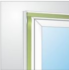
Bild 1: Bandverlegung bei der Fenstermontage
