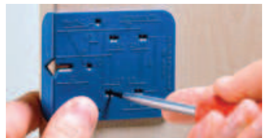
Ankörnlehre für Anschraub-Kreuzmontageplatten mit vormontierten Spanplattenschrauben für Mittelwandanschläge
