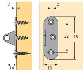
Befestigung mit Holzschrauben DIN 95 / DIN 97  $\phi$  3,5 und Spreizmuffen  $\phi$  5 mm
