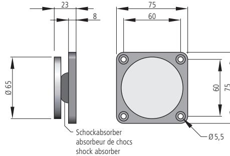
**Teleskopanker/Induit télescopique/telescopic doorplate ATS 75**
