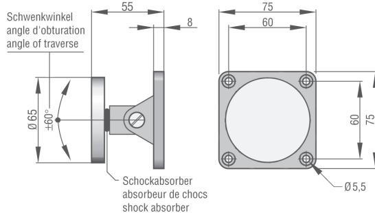
**Standardanker/Induit standard/standard doorplate ASS 65**
